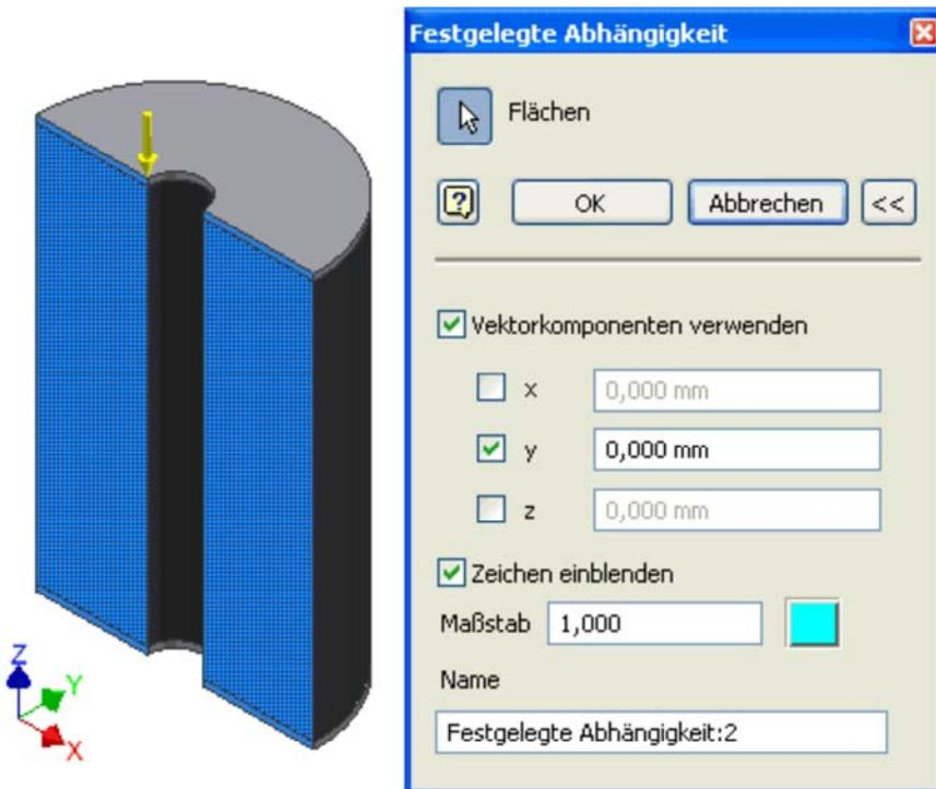
Mit dem reduzierten Netz gelingen unter Beachtung der Symmetriebedingungen nun vergleichbare Ergebnisse wie mit dem kompletten Modell (Deformationsdarstellung angepasst x5):
