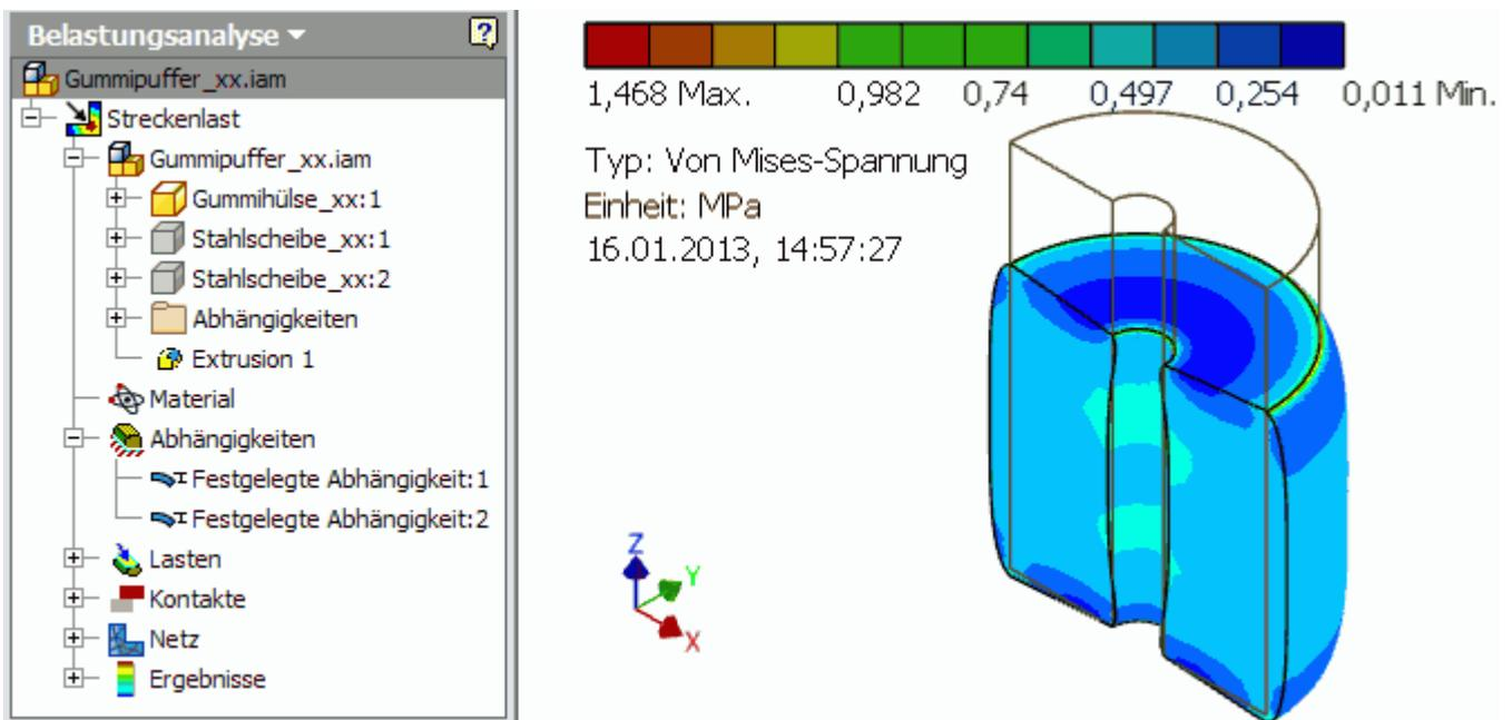
Das reduzierte Netz ermöglicht eine Verfeinerung insbesondere der globalen Elementgröße. Nach einer Anpassung des Maximalwertes der Farbskala auf einen sinnvollen Wert unterhalb des berechneten Extremwertes ergibt sich z.B. folgender Verlauf der Belastung:
