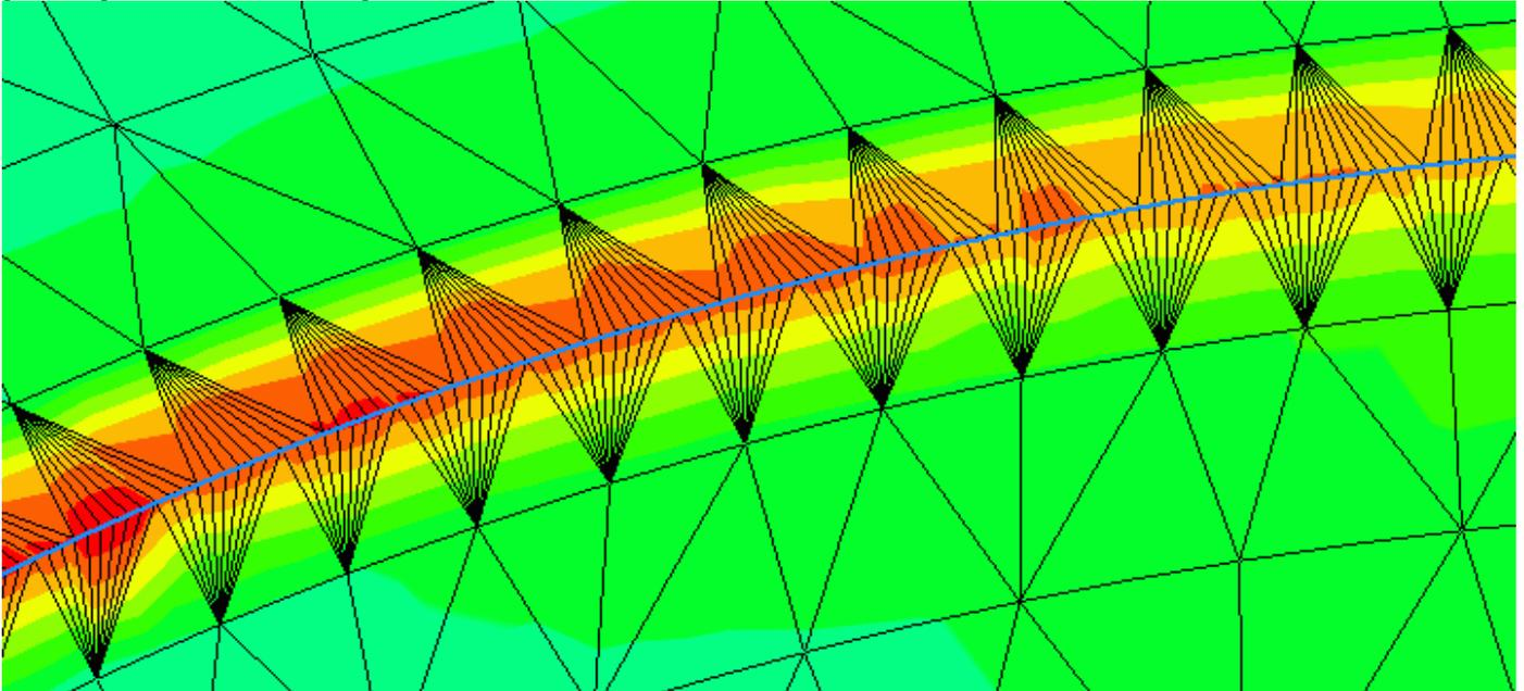
Man muss in den globalen **Netzeinstellungen** die **minimale Elementgröße** soweit verringern, dass eine "harmonische" Vernetzung im Bereich der Lochkanten entsteht:
