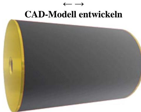
Bei dem Gummipuffer handelt es sich um einen Körper, der aus mehreren Teilen unterschiedlicher Materialien zusammengesetzt ist. Damit muss er im Autodesk Inventor als Baugruppe auf der Grundlage der Einzelteil-Modelle definiert werden. Die FEM-Belastungsanalyse erfolgt dann auf Basis dieser Baugruppe.
