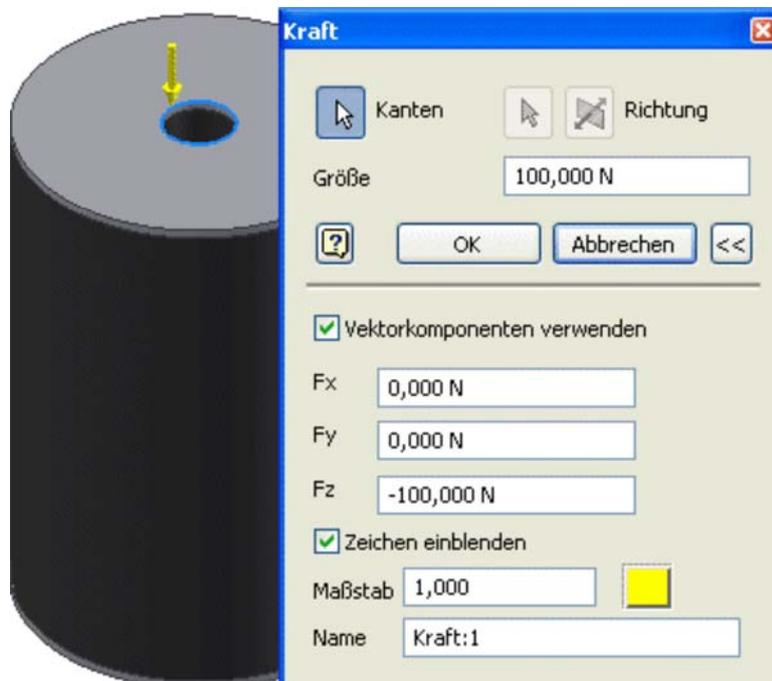
Die Druck-Kraft von 100 N wird der äußeren Lochkante der oberen Stahlscheibe zugewiesen.
