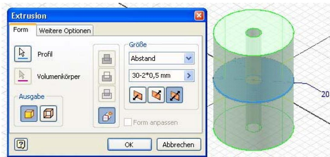
Die Gesamthöhe des Gummipuffers von 30 mm setzt sich zusammen aus der Höhe der Gummihülse und der Dicke=0,5xx mm der beiden Stahlscheiben. Auch bei der Gummihülse müssen wir unbedingt auf die **Verdrehsicherheit** bei der Modellentwicklung achten!
