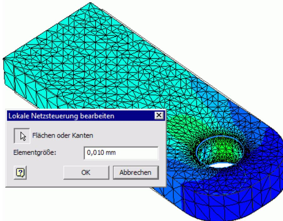
Das folgende Bild zeigt die Ergebnisse mit feiner lokaler Vernetzung der Lochkanten bei ausgeblendetem Netz:
