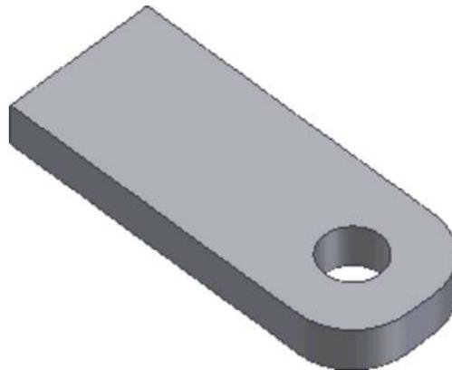
Das zu untersuchende Bauteil kann innerhalb eines CAD-Systems als CAD-Modell meist bedeutend leichter modelliert werden, als in einem FEM-Programm:
