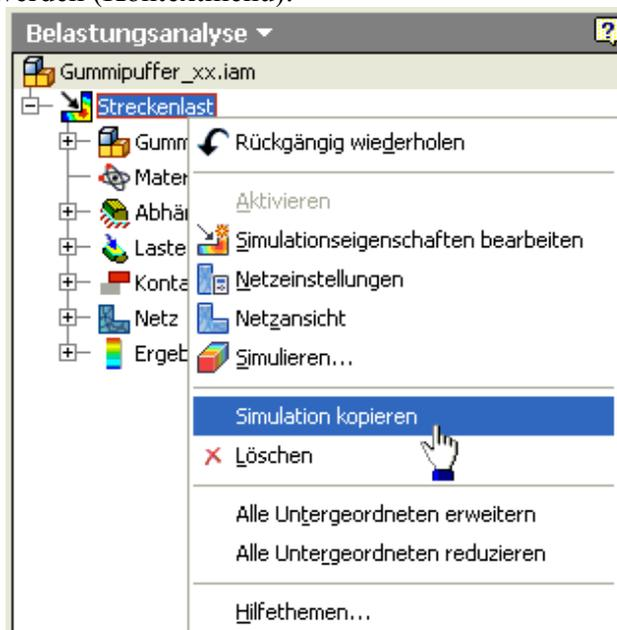
Das hat den Vorteil, dass man nach Vergabe eines neuen Bezeichners für die Simulation (z.B. Flächenlast), nur die Lasten bzw. einzelne Abhängigkeiten neu definieren muss.
