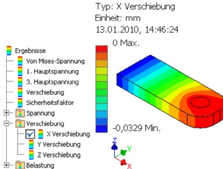
In diesem Fall ist das Abschalten der Deformationsdarstellung sinnvoll.
